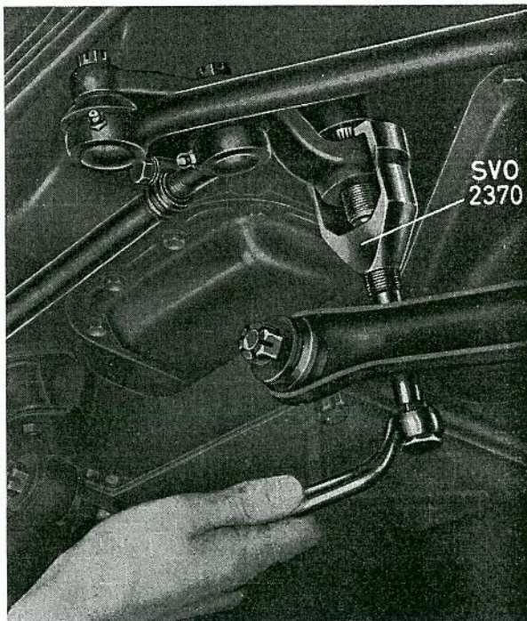
Bild 28. Demontering av pitmanarm.
