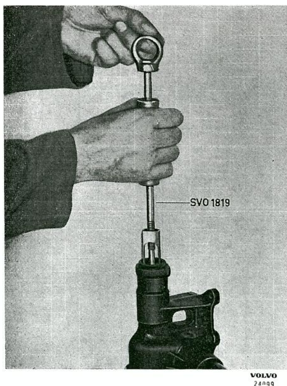
Bild 31. Demontering av styraxel och tätningring.
