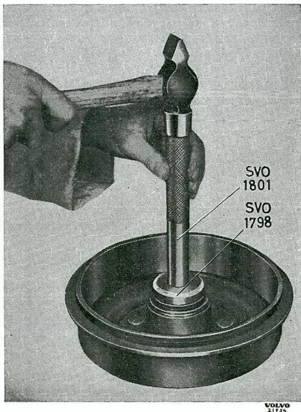
Bild 10. Montering av tätningsring.
